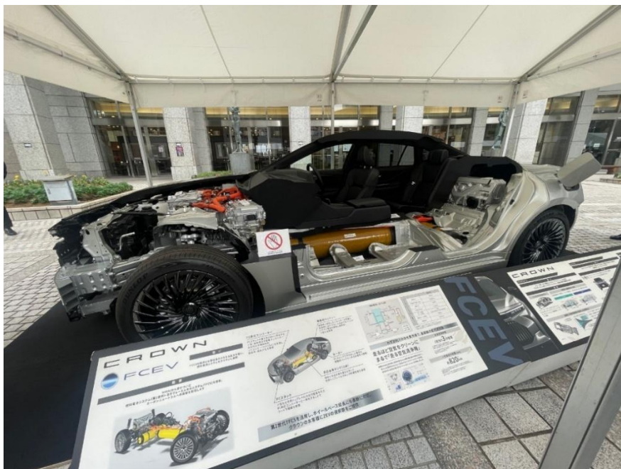
(画像 トヨタ クラウン FCEV (燃料電池電気自動車) カットモデル)
